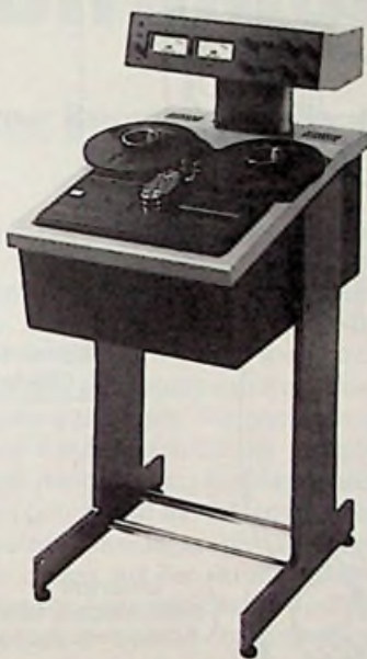
Bild 3: Verfahren Nr. 3: Hier ein PCM-Offenspulen-Tonbandgerät für Tonstudios. Die Mechanik wurde von Analog-Tonbandmaschinen übernommen. Die Aufzeichnung erfolgt mit feststehenden Köpfen (keine Schrägspuraufzeichnung), so daß die Bänder mit der Schere geschnitten werden können (Technics)
